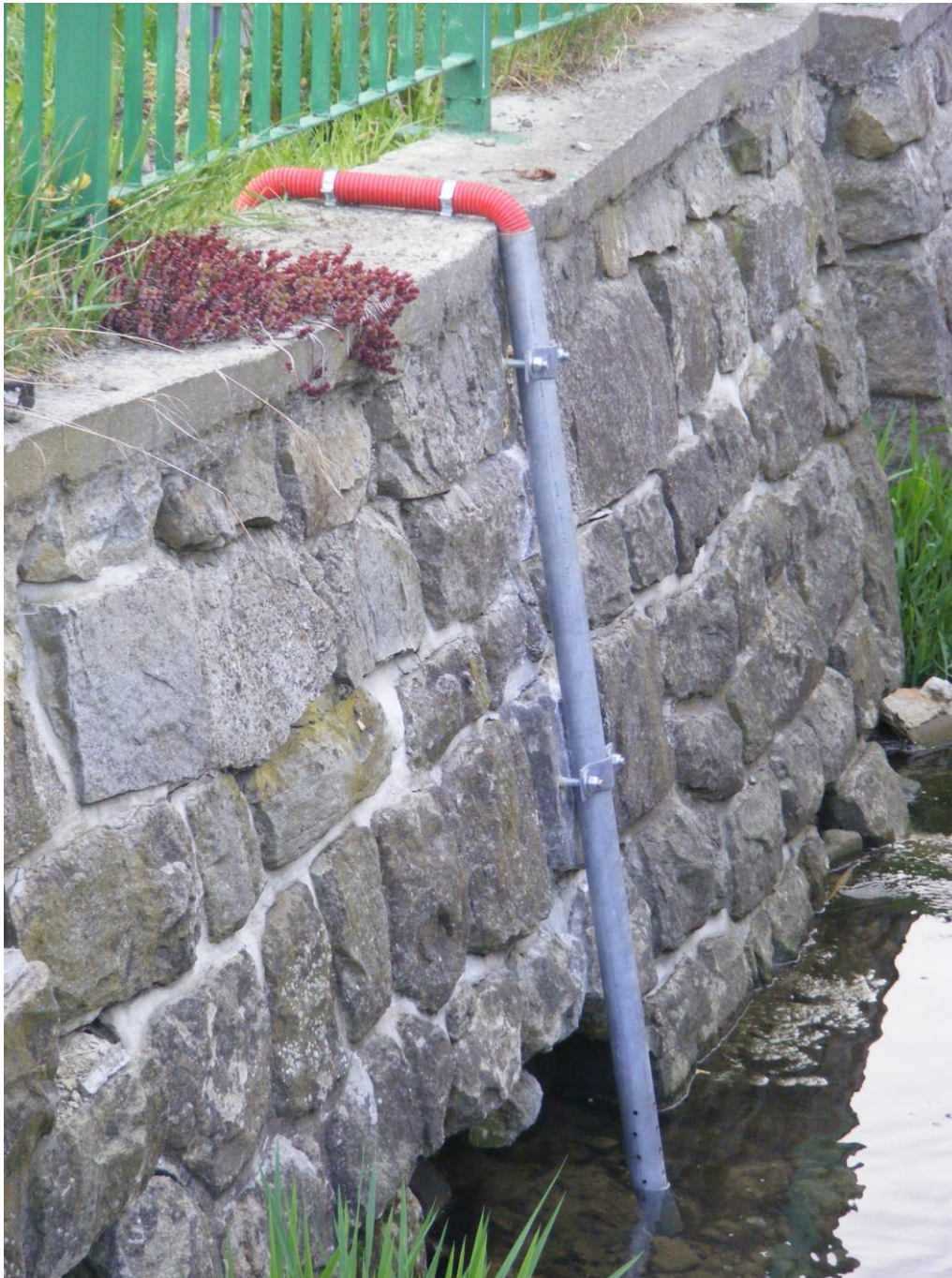
Příklad instalace manometrické sondy uchycené v kovové chráničce
